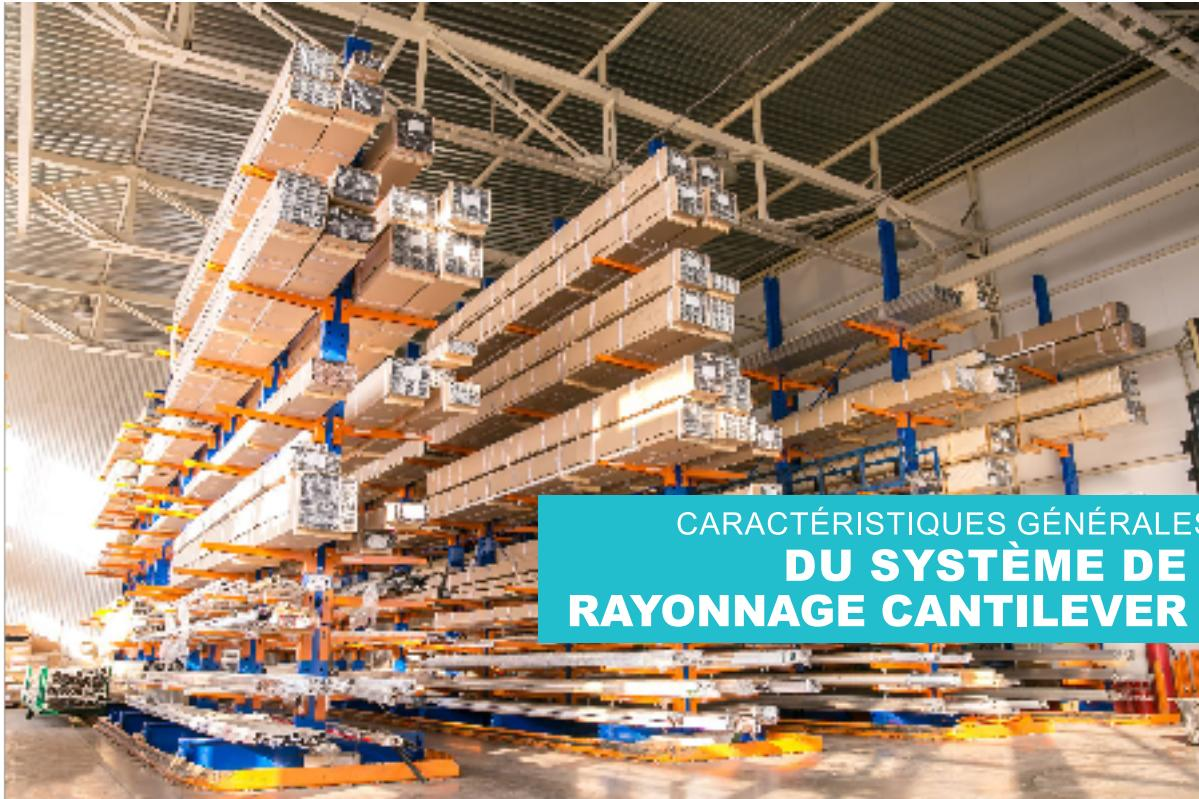
C'est la solution idéale pour stocker des charges longues ou de largeur variable, comme les profilés métalliques, tubes, moulures, panneaux en bois, tôles métalliques ou plastiques...
